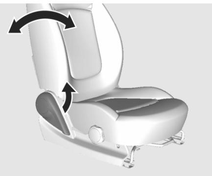
Dastakni torting, qiyalikni sozlang va dastakni qo'yib yuboring. O'rindiq yangi holatga o'ziga xos qarsillab joylashadi.
