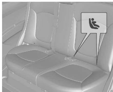
4. Bolalar o'rindiq'ini ikkita mahkamlagichning pastki tugunlari ustiga o'rnatishing va ushbu o'rindiq ishlab chiqaruvchisi tomonidan berilgan yo'riqnomaga rioya qilgan holda uni mahkamlang.
