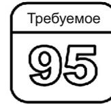
Заправляйте автомобиль неэтилированным бензином высшего сорта с октановым числом не ниже 95, соответствующий, как минимум. Не пользуйтесь бензином с октановым числом ниже указанного во избежание порчи автомобиля и повышенного расхода топлива. См. Топливо ↔ 8-51.
