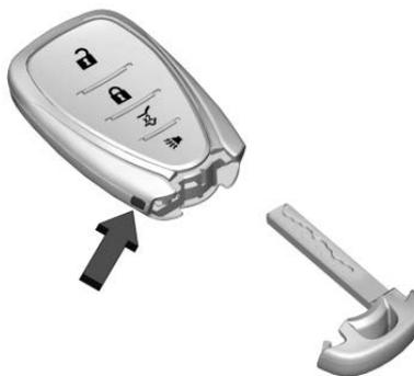
Извлеките ключ, нажав на кнопку сбоку в нижней части радиобрелока RKE и вытянув ключ наружу.
