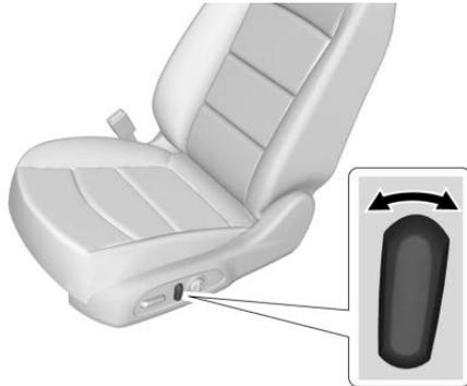
Для регулировки спинки сиденья с электроприводом (если он имеется):
