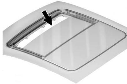
На уплотнителе и направляющих люка крыши может скапливаться пыль и грязь. Это может стать причиной неполадок при пользовании люком крыши, а также появления шума. Возможна также закупорка системы удаления воды. Периодически открывайте люк и удаляйте все посторонние предметы и рыхлую грязь. Протирайте уплотнение люка и зону уплотнения крыши чистой тряпкой, смоченной в мягком мыльном растворе. Не удаляйте смазку с люка.
