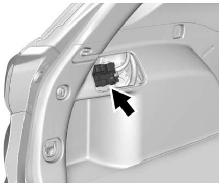
Для доступа к блоку предохранителей снимите декоративную панель. Автомобиль может быть оборудован не всеми показанными предохранителями и реле.
