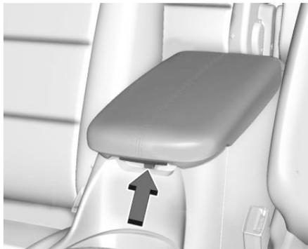
В центральной консоли имеется отсек для хранения; чтобы открыть его, поднимите рычаг спереди. Если предусмотрено комплектацией, там также могут находиться два USB-порта для передачи данных и зарядки.
