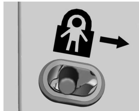
Предохранительный замок, если он установлен, находится возле внутренней кромки задних дверей. Порядок применения предохранительного замка:
