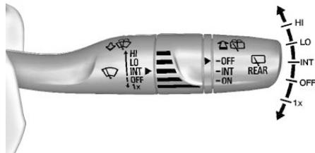
Стеклоочиститель ветрового стекла без датчика дождя системы Rainsense (показан рычаг с установленным режимом INT)
