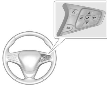
Используйте блок клавиш на правой спице рулевого колеса для перемещения по различным элементам меню дисплея.
