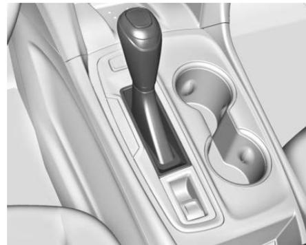
**Р:** В этом положении передние колеса блокируются. Устанавливайте селектор в положение Р (Парковка) при запуске двигателя, т.к. в этом случае автомобиль не сможет случайно тронуться.
