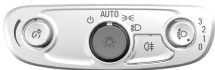
Выключатель наружного освещения расположен на приборной панели слева от рулевой колонки. Он имеет четыре положения.
