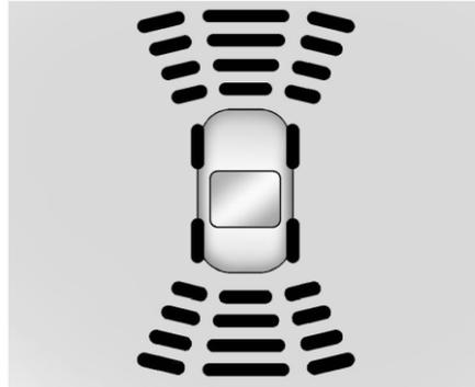
На некоторых автомобилях комбинация приборов может быть оборудована дисплеем системы помощи при парковке с полосками, которые показывают расстояние до препятствия и информацию о его расположении. По мере приближения препятствия на диаграмме загорается больше полосок, кроме того, они могут менять цвет с желтого на янтарный, а затем на красный.
