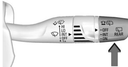
Управление очистителем/омывателем заднего стекла выполняется путем поворота конца рычага очистителя ветрового стекла.
