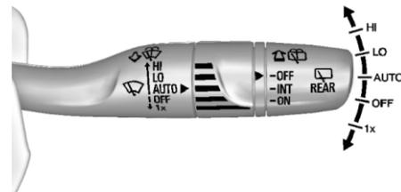
Стеклоочиститель ветрового стекла с датчиком дождя системы Rainsense, в соответствующей комплектации (показан рычаг с установленным режимом AUTO)
