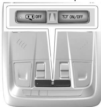
Кнопки управления потолочными плафонами расположены на верхней консоли.
