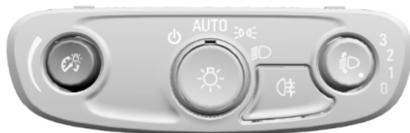
Яркость экрана дисплея в комбинации приборов, дисплея информационно-развлекательной системы и органов управления ею, органов управления на рулевом колесе и остальных оснащенных подсветкой приборов, а также индикаторов состояния различных функций, можно отрегулировать. Для регулировки яркости предусмотрена ручка, расположенная на приборной панели возле рулевой колонки. Поверните ручку по часовой стрелке или против часовой стрелки для повышения яркости или затемнения ламп.
