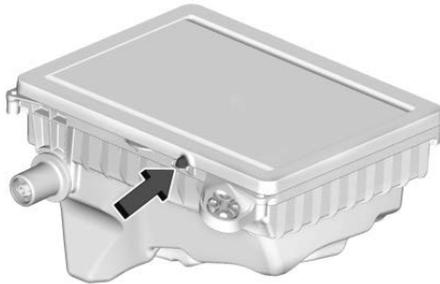
1. Ориентируйте воздухоочиститель /воздушный фильтр по метке на основании корпуса воздушного фильтра /воздухоочистителя и установите его. Наружное уплотнение воздухоочистителя
