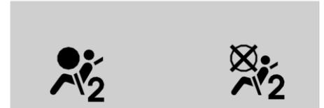
При запуске автомобиля в ходе проверки системы индикатор состояния подушки безопасности пассажира попеременно включает на несколько секунд символы включенной и отключенной подушки.
