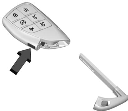
Встроенный в радиобрелок механический ключ открывает дверь водителя и перчаточный ящик.
