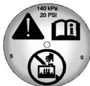
1. После остывания системы охлаждения, крышки с предохранительным клапаном расширительного бачка и верхнего шланга радиатора снимите крышку с предохранительным клапаном расширительного бачка.
