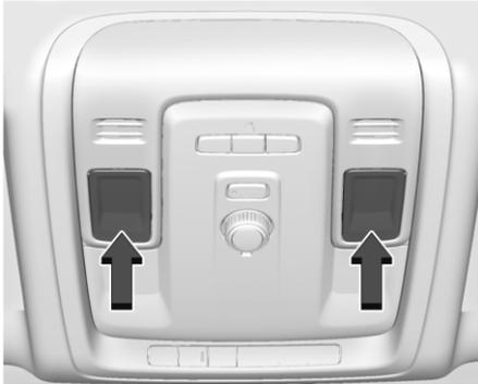
Кнопки управления передними плафонами для чтения расположены на верхней консоли. Чтобы включить или выключить передние плафоны для чтения, нажмите на них.
