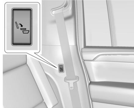
**Переключатель на задней панели со стороны водителя**
