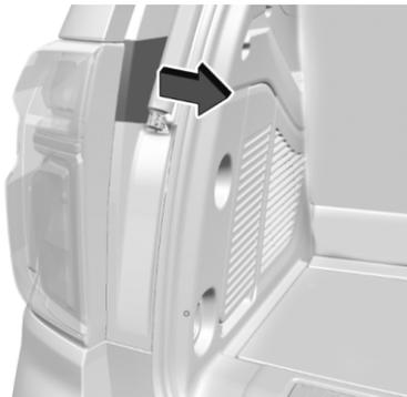
2. Снимите среднюю часть отделки, потянув ее к центру автомобиля, чтобы освободить защелки.
