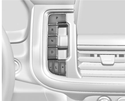
Если дважды нажать на ENGINE START/STOP (ПУСК/СТОП ДВИГАТЕЛЯ) при движении с относительно высокой скоростью, то двигатель глушится, а коробка передач автоматически переключается на нейтраль (N). После остановки автомобиль можно перевести в стояночное положение (P).
