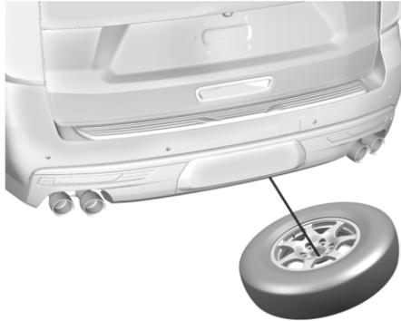
7. Чтобы получить доступ к фиксатору колесного диска, наклоните колесо к автомобилю, слегка ослабив трос.
