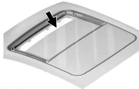
На уплотнителе и направляющих люка крыши может скапливаться пыль и грязь. Это может стать причиной неполадок при пользовании люком крыши, а также появления шума. Возможна также закупорка системы удаления воды. Периодически открывайте люк и удаляйте все посторонние предметы и рыхлую грязь. Протирайте уплотнение люка и зону уплотнения крыши чистой тряпкой, смоченной в мягком мыльном растворе. Не удаляйте смазку с люка.
