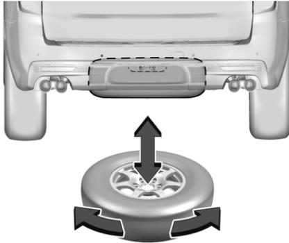
7. Убедитесь, что колесо надежно закреплено. Потяните за колесо, покачайте его и постарайтесь повернуть. Если колесо поддается, подтяните трос ключом. Проверьте надежность крепления колеса, когда будете в следующий раз согласно предусмотренному регламенту проверять давление воздуха в шине или когда потребуется снять запасное колесо для получения доступа к другим компонентам во время обслуживания.
