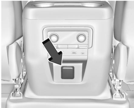
Розетка на 220 вольт включается вместе с зажиганием. Ток подается в розетку на 220 вольт, когда к ней подсоединен тот или иной электроприбор. Розетка совместима с электрооборудованием мощностью не более 400 ватт. Следите за тем, чтобы не подключать устройства, суммарная мощность которых превышает 400 ватт.
