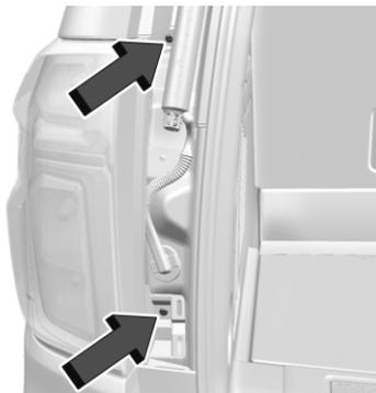
4. Снимите два винта заднего фонаря.
