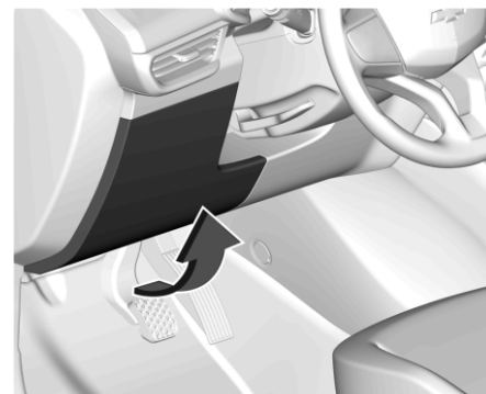
Блок предохранителей в приборной панели
